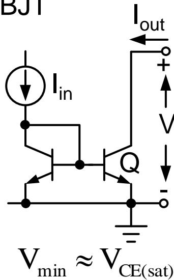
$$V_{min} \approx V_{CE(sat)}$$
