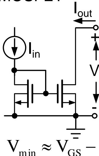
$$V_{min} \approx V_{GS} - V_T$$
